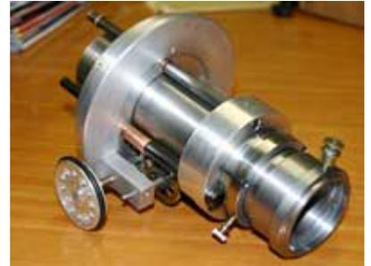
Vous constaterez qu'il y a 2 molettes donc 2 vitesses de mise au point. Une pour le dégrossi de la focalisation, l'autre pour terminer avec finesse la mise au point. 3 mm d'avance pour 1 tour, c'est précis.
