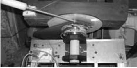
Ce type de frein peut se trouver sur des aménagements de machine-outil du type déroulage et tension de bande de papier dans les imprimeries ou sur des maintiens de porte coupe-feu. Caractéristique du frein 12-24 volts 24 watt.
