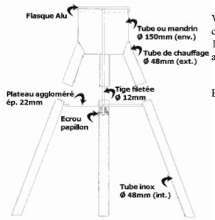
Voici une embase stable et qui ne rouille pas. J'y ai mis au centre un plateau de bois tenu par une tige filetée de diamètre 12 et vissée dans le flasque en le serrant avec le plateau elle arc-boute les 3 pieds ce qui fait un raidisseur
